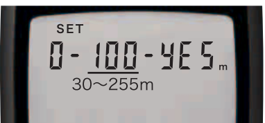
ケーブル長の補正モード画面 (30~255m) ◀▶ で切替
